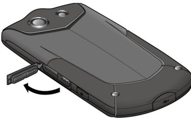
2. Con cuidado inserta una tarjeta microSD en la ranura respectiva que está a la izquierda con las terminales doradas mirando hacia abajo. Empuja suavemente la tarjeta en la ranura y cierra la tapa.
