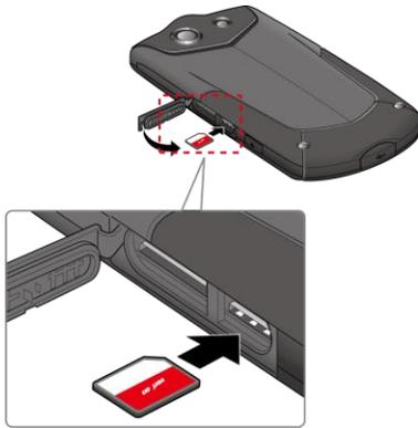
3. Presiona alrededor de los bordes de la tapa de las ranuras para las tarjetas microSD/tarjeta SIM para asegurarte de que estén cerradas.
