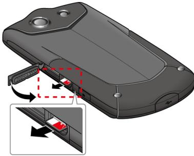
4. Presiona alrededor de los bordes de la tapa de las ranuras para las tarjetas microSD/tarjeta SIM para asegurarte de que estén cerradas.
