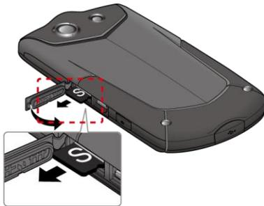
3. Presiona alrededor de los bordes de la tapa de las ranuras para las tarjetas microSD/tarjeta SIM para asegurarte de que estén cerradas.
