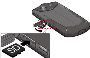
3. Presiona alrededor de los bordes de la tapa de las ranuras para las tarjetas microSD/tarjeta SIM para asegurarte de que estén cerradas.
