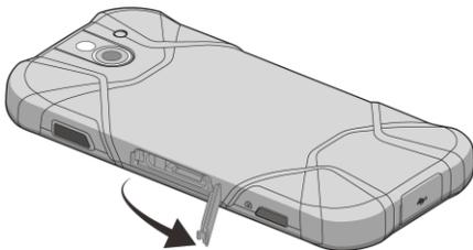
2. Insérez votre ongle dans la rainure de l'extrémité supérieure du plateau et extrayez celui-ci.
