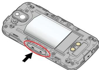
**Advertencia:** Asegúrate de que la tapa de la ranura SIM/microSD esté cerrada correctamente para que el teléfono mantenga la resistencia al agua.
