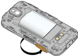
4. Presiona suavemente la tarjeta SIM con el dedo. La tarjeta sale por sí sola. Extrae la tarjeta SIM original de la ranura.
