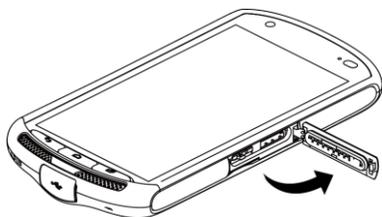
2. Coloca la tarjeta SIM en la bandeja de tarjeta SIM de manera que el extremo cortado de la tarjeta siga la forma de la bandeja. Sosteniendo la tarjeta y la bandeja con tus dedos, insértalas en la ranura de la tarjeta SIM a la izquierda y cierra la tapa.
