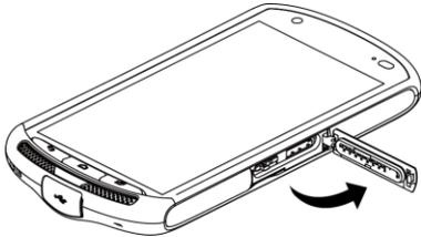
2. Con cuidado inserta una tarjeta microSD en la ranura respectiva que está a la derecha con las terminales doradas mirando hacia arriba. Empuja suavemente la tarjeta en la ranura y cierra la tapa.
