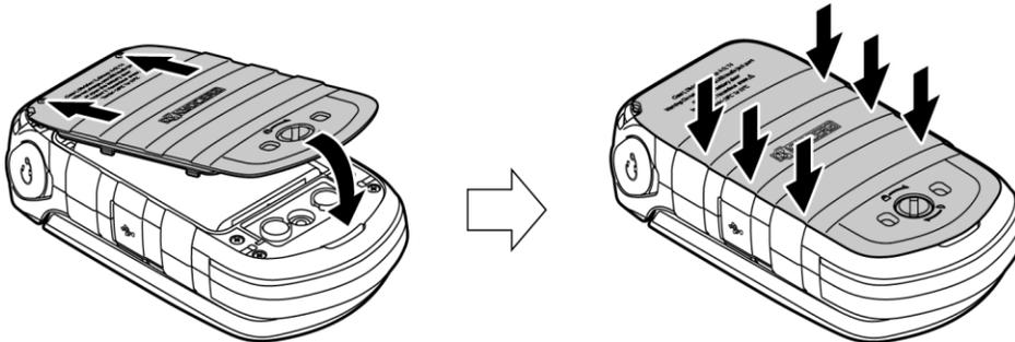
**Advertencia:** Presione todos los costados de la tapa de la batería para asegurarse de que esté debidamente cerrada. Esto conservará la función de resistencia al agua del teléfono.
