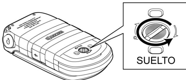
**Nota:** El tornillo de la tapa de la batería está montado permanentemente en la tapa y no puede extraerse.
