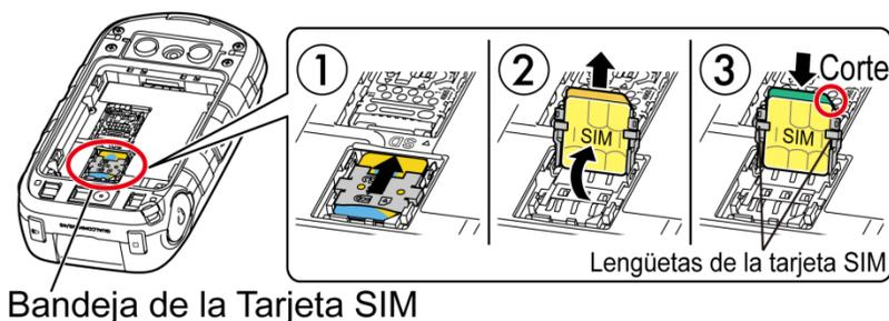
**Nota:** Asegúrese de insertar la tarjeta nano SIM en la dirección correcta.
