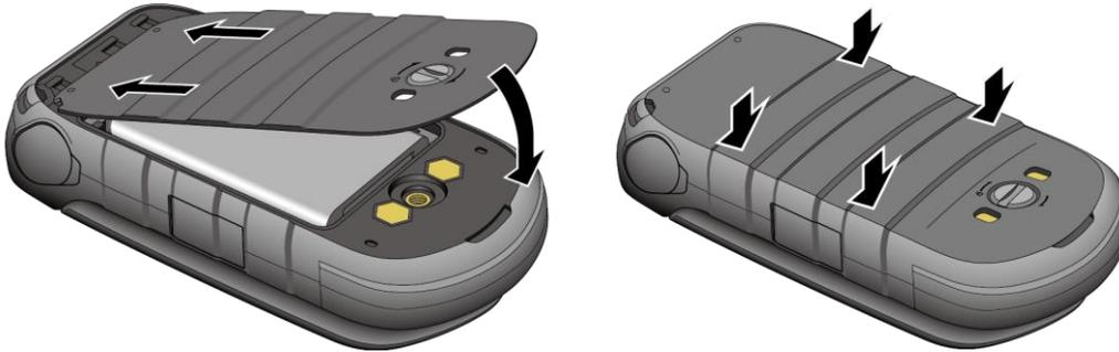
**Advertencia:** No se olvide de presionar todos los costados de la tapa de la batería para asegurarse de que la tapa esté debidamente cerrada y que la resistencia al agua del teléfono permanezca intacta.
