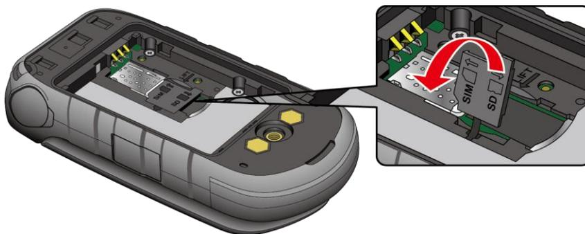
3. Inserte la tarjeta microSD en la ranura con las terminales doradas mirando hacia abajo. Empuje suavemente la tarjeta hasta que se encastre en su lugar.
