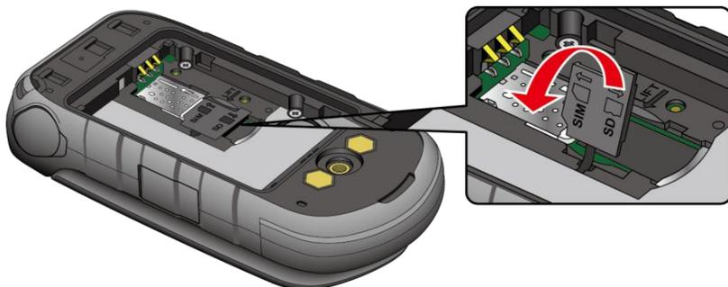
3. Presione suavemente la tarjeta SIM con el dedo. La tarjeta sale por sí sola. Extraiga la tarjeta SIM original de la ranura.
