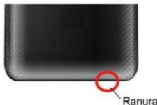
2. Inserte la tarjeta microSD en la ranura de la tarjeta microSD con las terminales doradas mirando hacia abajo. Empuje suavemente la tarjeta hasta que se encastre en su lugar.
