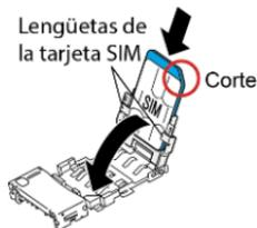
4. Deslice la lengüeta en la dirección de la flecha para bloquearlo. La parte inferior de la tarjeta SIM debe apoyarse en el tope.
