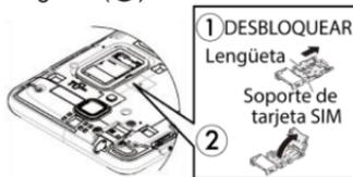
3. Inserte la tarjeta nano SIM en la lengüeta del soporte de tarjeta SIM, asegurándose de que la esquina recortada se encuentre en la parte superior derecha y la tarjeta esté insertada detrás de las pestañas guía de SIM (3).
