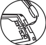
5. Asegúrese de que el cordón se encaje en el gancho dentro del orificio.
